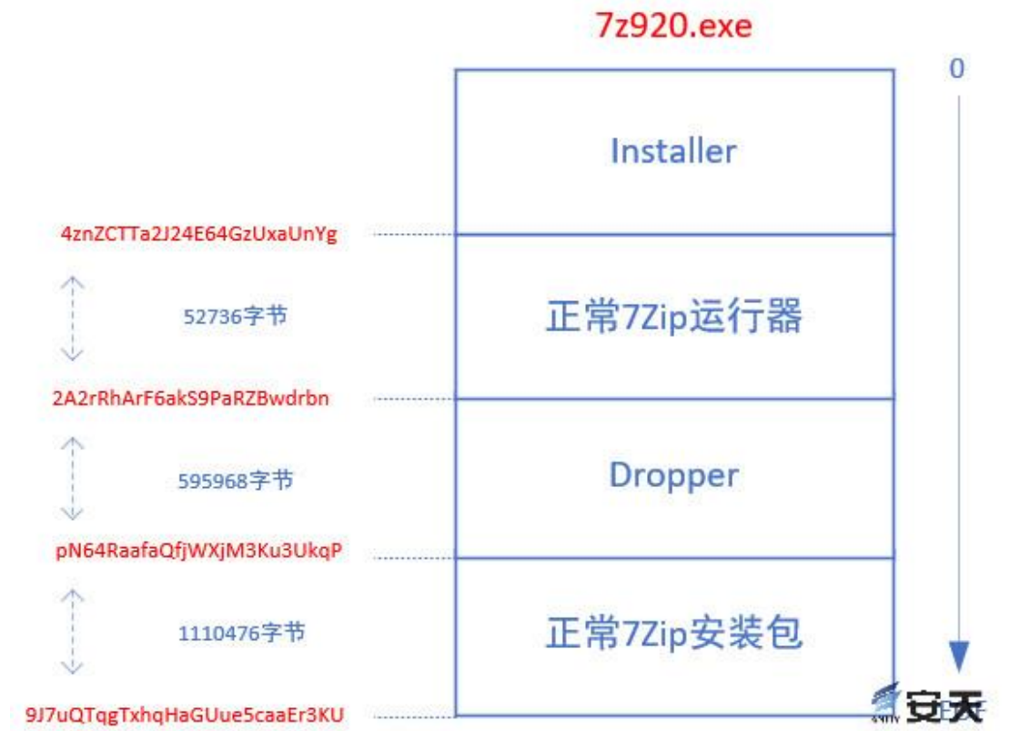
图 2-2 安装包诱饵结构图示
